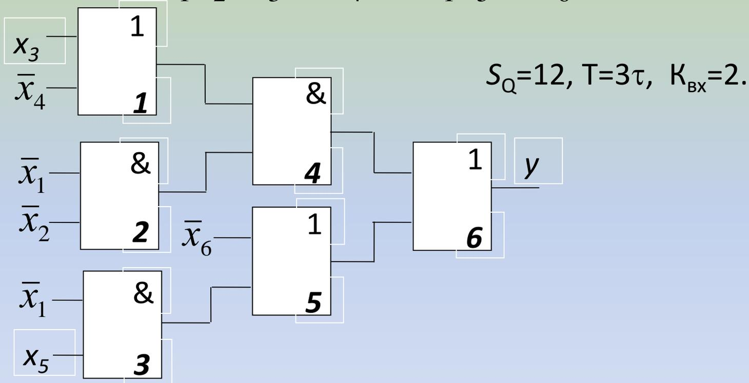
Построим схему по второму выражению с ограничением на число входов в элементы, равное двум
