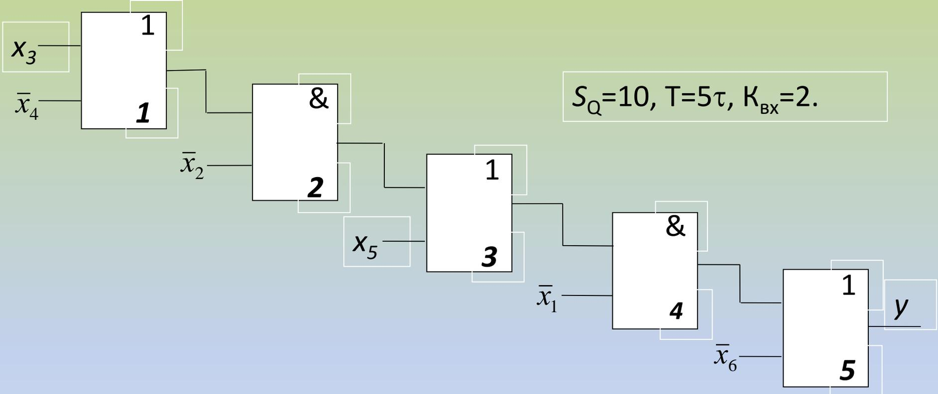
Схема, построенная по второму выражению, по критерию цены схемы является более предпочтительной по сравнению с первой схемой, а по критерию минимальной задержки - лучше первая схема.
