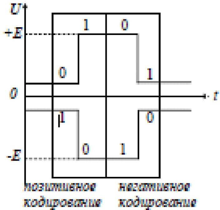
При изменении способа кодирования двоичного сигнала функция одной и той же электронной схемы, реализующей некоторый логический элемент, меняется на противоположную.
