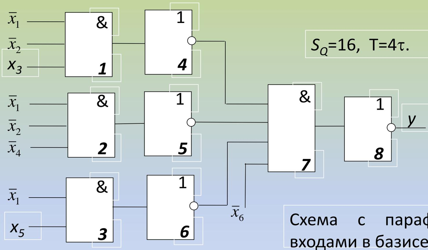
При построении схемы на элементах базиса (И, НЕ) по МДНФ задержка схемы, в общем случае, составляет  $T=4\tau$ . А при использовании однофазных входов -  $T=5\tau$ .
